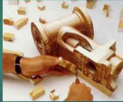
Figura 5- Ejemplo de piezas que se podría fabricar con la tecnología LOM actual
