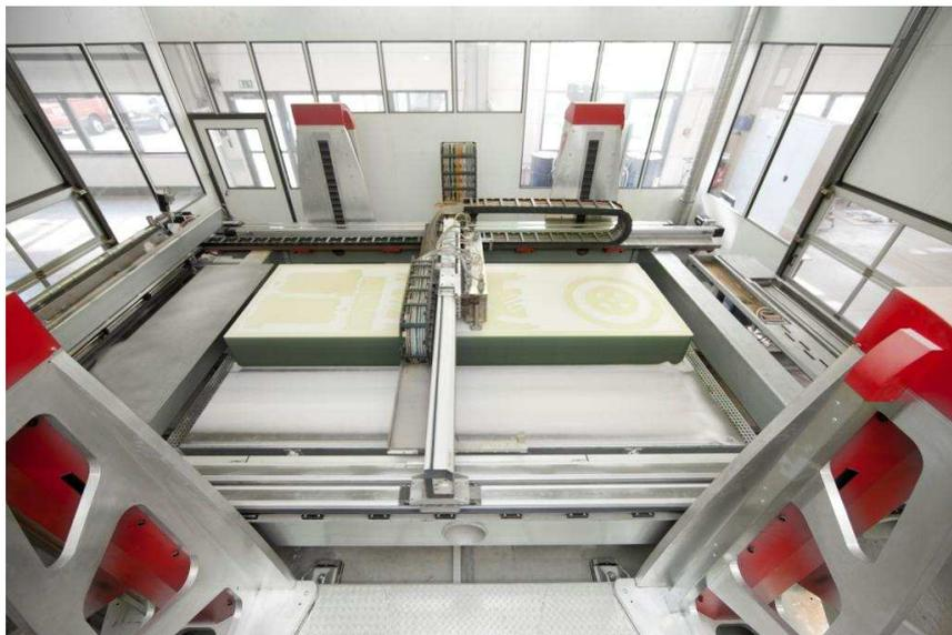
Figura 1 – Máquina de FA que utiliza polvo de diferentes polímeros
