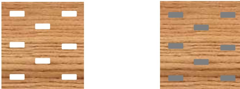
Figura 9- Inserción de fluidos inyectados en canales de las piezas
